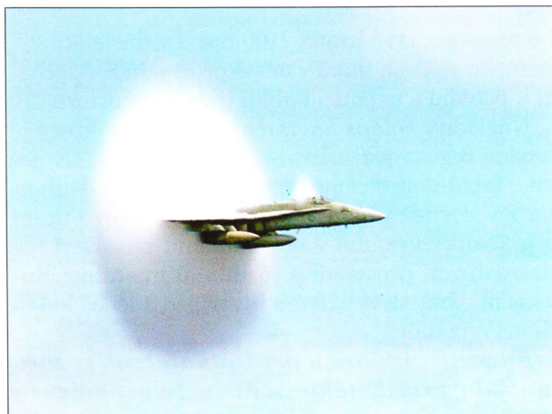
Obr. 2. Sférický tvar rázové vlny /oblak kolem křídel/ u bojového letounu při dosažení rychlosti zvuku.
